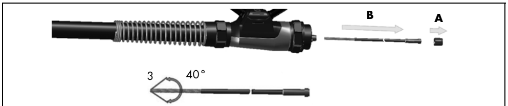
Abb. 3 Führungsspirale entnehmen und entgraten
